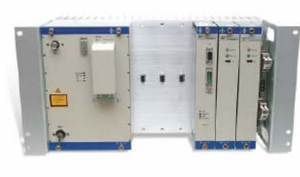
Рис.2 Внешний вид платформы 1570ВВ, монтажная панель на 10мест
